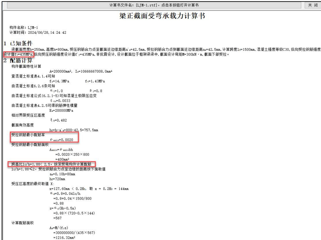
图 1-22 深梁纵向受拉钢筋配筋率
